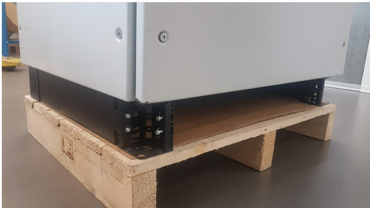
Figure 8 ouverture à l'arrière de l'armoire. La plinthe doit rester ouverte pour permettre le passage des câbles et le refroidissement.
