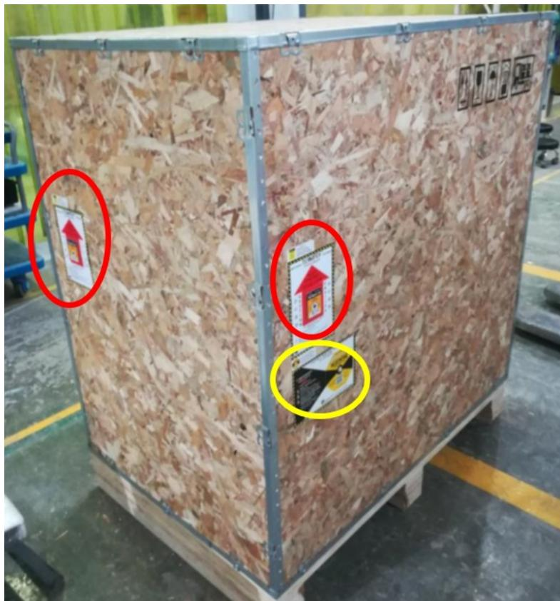
Figure 22 Emplacement des TiltWatch et ShockWatch
