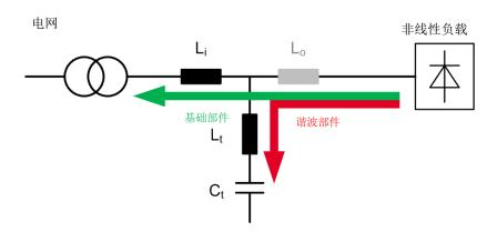
图 17 ecosine max 无源谐波滤波器 (有和无负载电抗器 Lo)的工作原理
