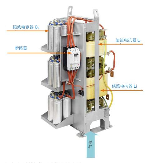
图 19 FN3471/81/73/83 滤波器的设计 (型号 E0XXSXX)
