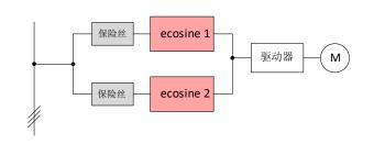
根据 表 30 和表 31 以及章节 8.3.5,对于具有一个 ecosine 滤波谐波用于多个驱动器的应用场合,在任何情况下都需要为驱动器提供线路侧保险丝保护以及正确的滤波器保护。
