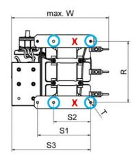
图 6 滤波器 FN 3471、FN 3473、FN 3481 和 FN 3483 的 允许(蓝色)和严禁(红色) 选择的固定点
