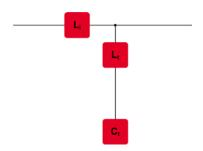
图 15 FN 3471, FN 3473, FN 3481 和 FN 3483 滤波器系列的示意图
