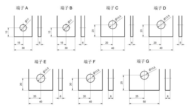
图 4 不同端子尺寸的图纸 (根据 表 20)
