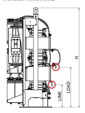
图 10 滤波器 FN 3471, FN 3473, FN 3481 和 FN 3483 的线路和负载端子的位置
