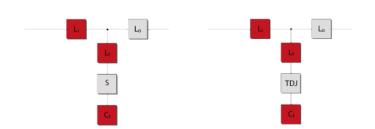
图 1 FN3470, FN3472, FN3480 和 FN3482 的滤波器配置
