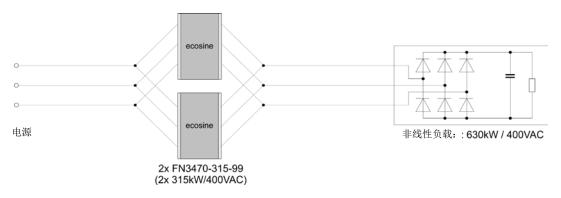
图 21 并联 2 个滤波器用于更大功率负载的应用示例
