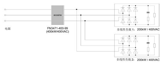
图 20 滤波器有多个负载的应用示例
