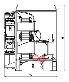
图 9 滤波器 FN 3470, FN 3472, FN 3480 和 FN 3482 的线路和负载端子的位置
