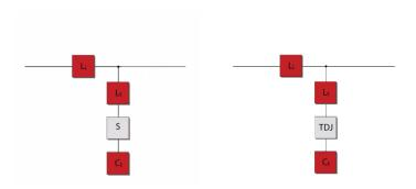
图 2 FN3471, FN3473, FN3481 和 FN3483 的滤波器配置
