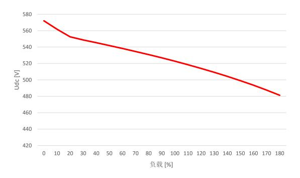
图 14 驱动器直流链接电压与负载的比较 (二极管整流器前端,带 FN 3471 系列和 4% Ldc 的驱动器)
