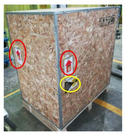
图 22 TiltWatches 和 ShockWatch 的位置
