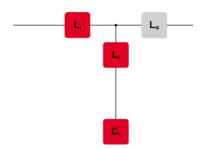
图 16 FN 3470、FN3472、FN 3480 和 FN 3482 滤波器系列的示意图 ecosine max 滤波器基础模块的一般工作原理详见图 17。
