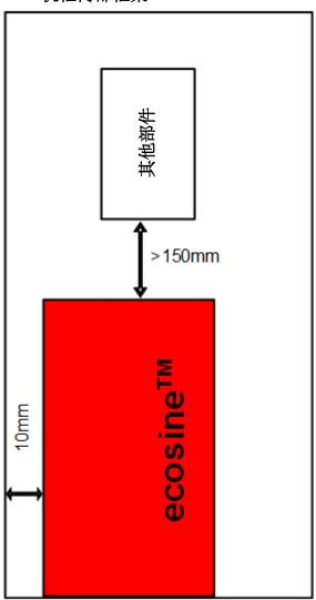
图 23 机柜内部的间隙
