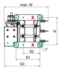
图 25 滤波器 FN 3471, FN 3473, FN 3481 和 FN 3483 的 首选(绿色)和严禁选择(红色)的固定点。
